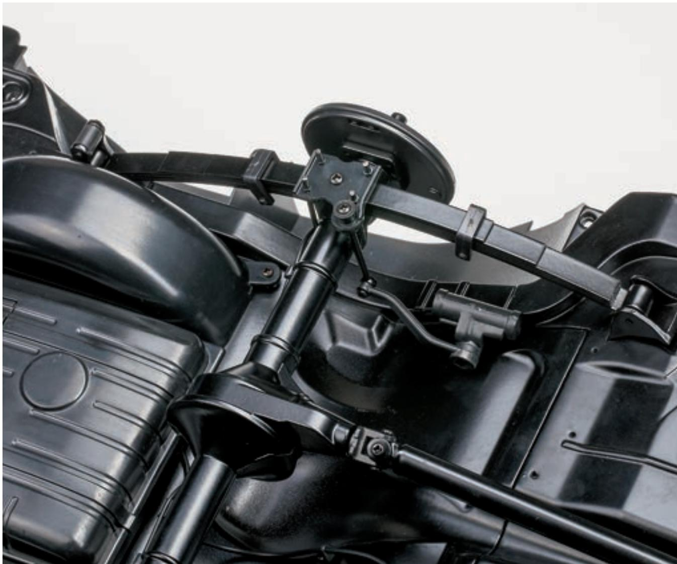
Вставьте свободный конец тяги правого рычага амортизатора в отверстие правой подкладки рессоры и закрепите его при помощи винта 2,0×3 с прессшайбой (GM).
