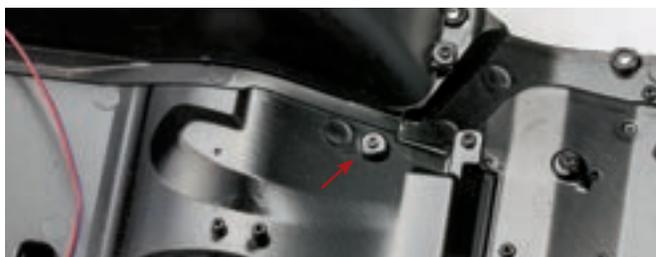
Установите собранный задний левый амортизатор на шасси модели. Совместите крепежный штифт корпуса амортизатора с ответным отверстием шасси, расположенным около левого заднего лонжерона шасси позади переднего кронштейна рессоры. Закрепите корпус амортизатора винтом 1,7×4 (AP) с верхней стороны шасси модели.
