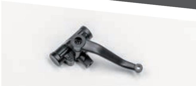
Аналогичным образом при помощи винта 1,7×5 (BP) закрепите рычаг на корпусе правого заднего амортизатора. Рычаги левого и правого задних амортизаторов взаимозаменяемы.
