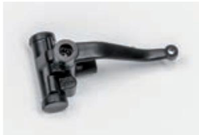
Установите рычаг заднего амортизатора поверх корпуса левого амортизатора. Совместите отверстие рычага, расположенное в его более широкой части, с центральным отверстием корпуса заднего амортизатора. Закрепите детали при помощи винта 1,7×5 (BP). После фиксации детали должны двигаться относительно друг друга с небольшим усилием.
