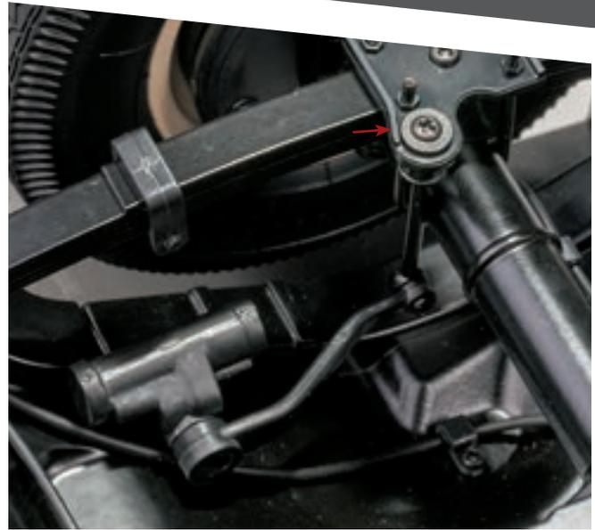
Вставьте свободный конец тяги рычага заднего амортизатора в отверстие подкладки рессоры. Закрепите тягу в отверстии подкладки при помощи винта 2,0×3 с пресс-шайбой (GM). По окончании фиксации тяга имеет свободный ход в отверстии подкладки.
